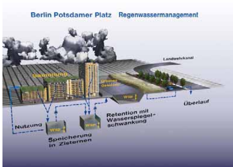
Abb. 1 Schema Regenwassermanagement am Potsdamer Platz
