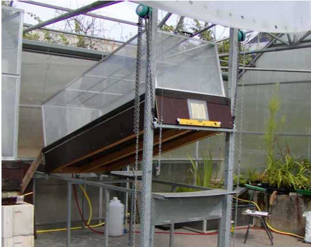
Abb 5 Messtisch mit 2,5 m Länge, bis 35° neigbar
