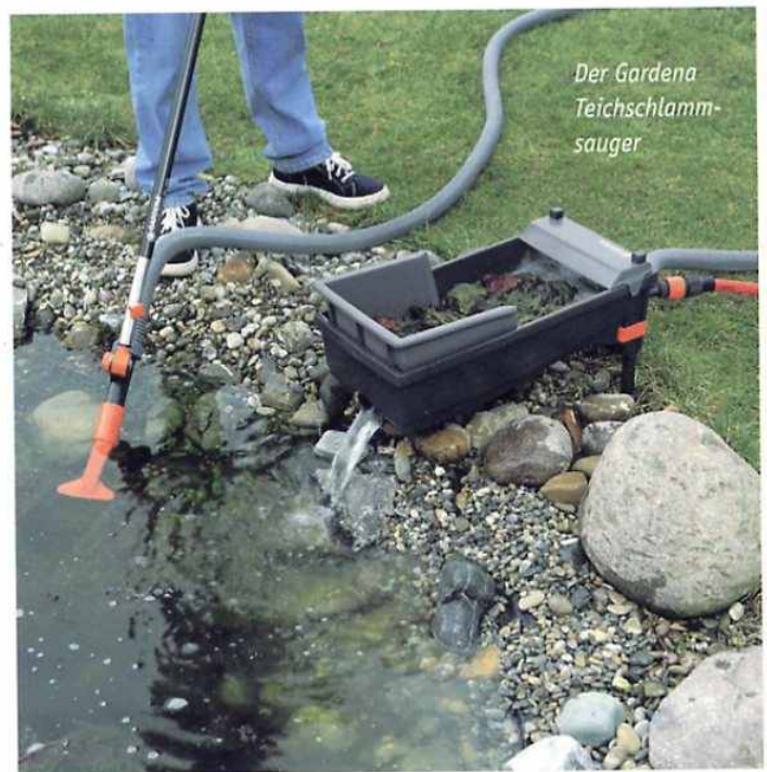
Herzstück des Gardena Teichschlammsaugers: der Auffangbehälter
