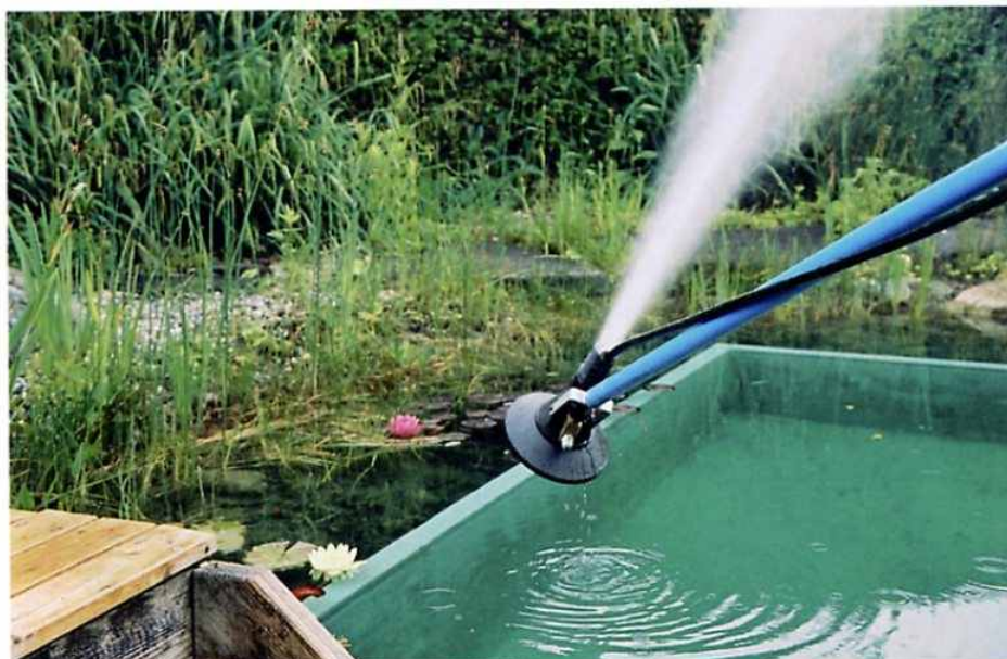
Der Schlammsauger von Arnold basiert auf dem Injektorprinzip.
